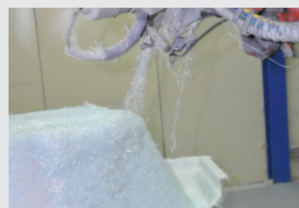
Armare cu rășină sintetică și fibră de sticlă sau spumă poliuretanică PU PLUS
