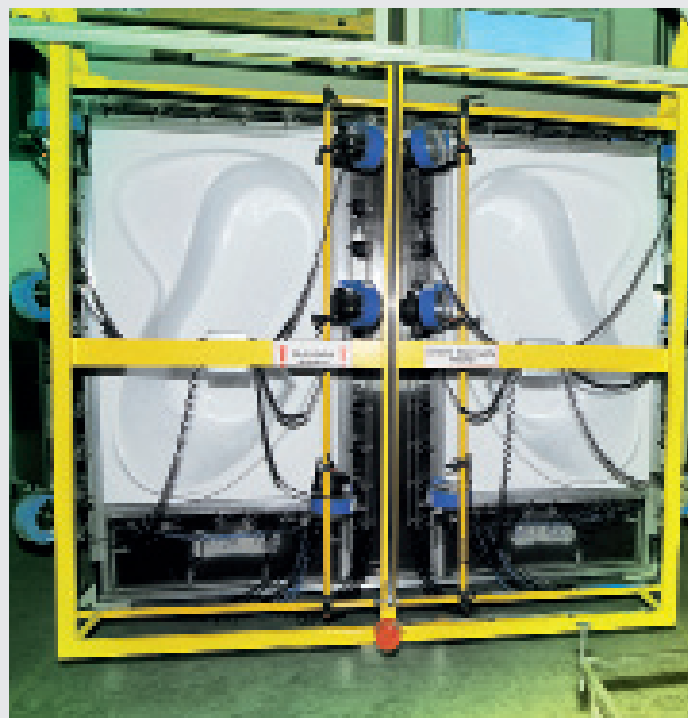
Armare cu rășină sintetică și fibră de sticlă sau spumă poliuretanică PU PLUS
