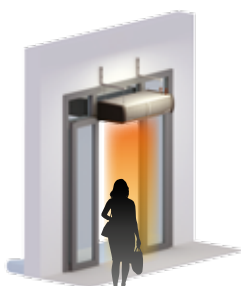
B) Открытые двери – вентиляторы завес работают на скорости установленной на регуляторе скорости.
