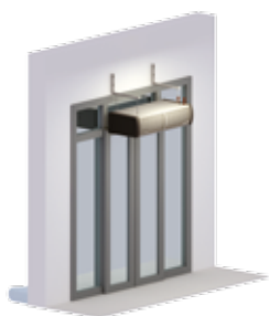
A) Закрытые двери – вентиляторы завес не работают.
