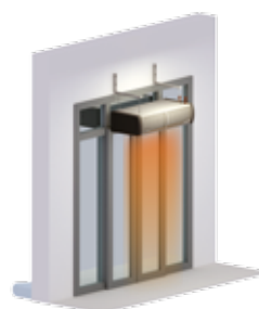
D) Закрытые двери – вентиляторы завесы работают на маленькой скорости вращения.
