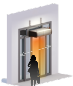
B) Двери открываются – вентиляторы увеличивают скорость вращения.
