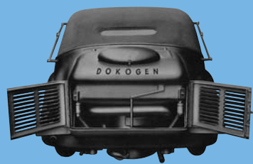
Škoda Superb, model 1942, cu generator de gazeificare a lemnului
